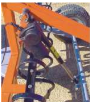
Regulación de la altura mediante actuador eléctrico
