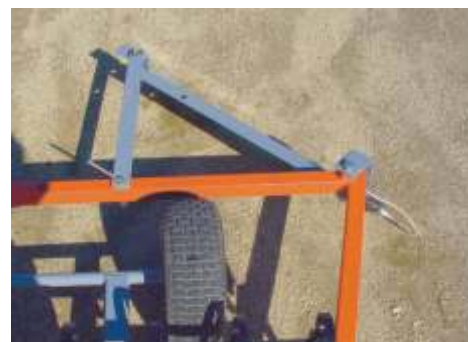
Cuchilla inclinable para recuperar la arena acumulada en los laterales de la pista
