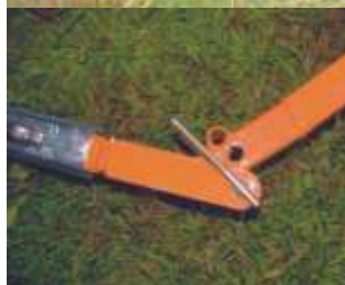
Regulación manual de la altura de corte y el desplazamiento lateral respecto al ATV
