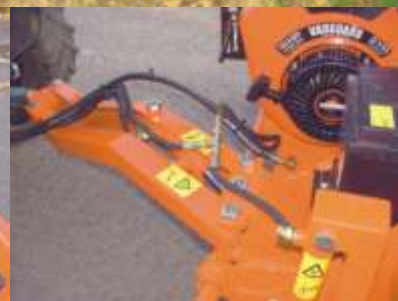
Regulación hidráulica de la altura de corte y el desplazamiento lateral respecto al ATV
